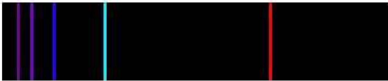
Spettro dell'Idrogeno in Laboratorio
